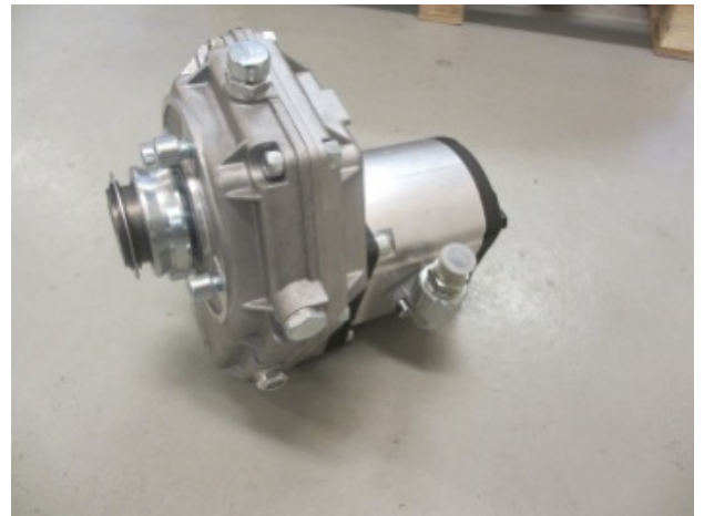
Pumppu asennettuna vaihdelaatikkoon
