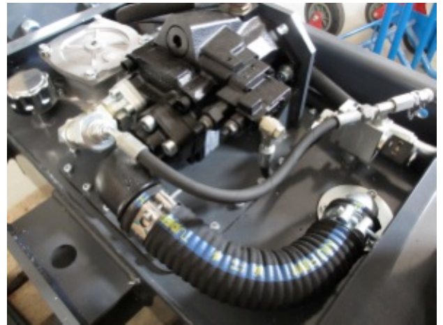
Asennettu 65cc kuormantunteva pumppu
